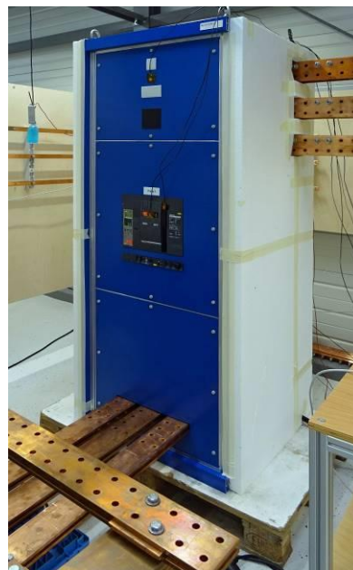
Prova del tipo di un quadro elettrico con interruttore di potenza fino a 1600 kVA.
