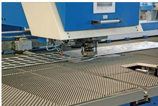
Les rondelles sont poinçonnées dans les chutes de tôle
