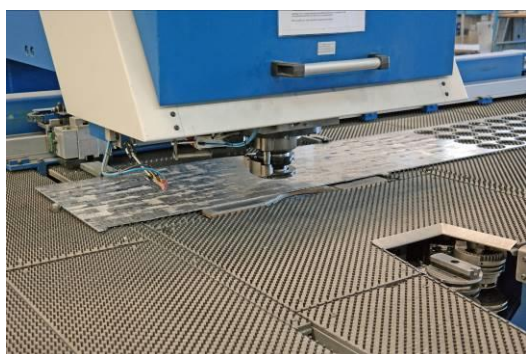
L'outil découpe les rondelles dans la tôle
